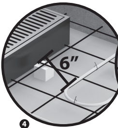
4 Dégagement des drains et obstacles
