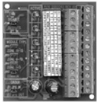
Le module de relais à distance se monte sur un châssis en plastique à l'intérieur d'un boîtier MFC-A.
