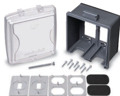
Simple et rapides à installer, les couvercles en service non métalliques Code Keeper mc s'adaptent aisément à diverses configurations de sorties. Plus nécessaire d'enlever puis replacer les vis de la prise – il suffit de desserrer les vis de l'appareil existant et de glisser le couvercle par-dessus.
