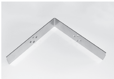
ELB-20 : Plaque de fixation pour tuyau de descente de gouttière, pour maintenir le câble en place à l'entrée du tuyau de descente. Le câble est fixé à la plaque à l'aide d'attaches en plastique.
